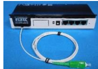
Vue face arrière montrant tous les accès du même côté
