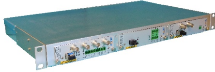
Rack 19"1U modulaire complet Trois cassettes 7TE insérées
